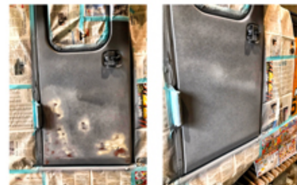
細かなパテの巣穴部分にスポットパテを施し研ぎ作業を行い、下地塗装を行います。
