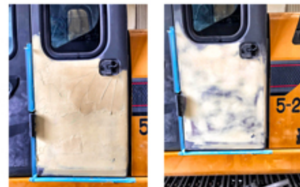
パテを研ぎ、さらに仕上げパテ付を行い仕上げの研ぎ作業を行います。
