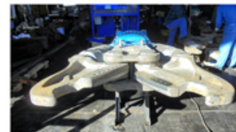
先端ツース部分が消耗
