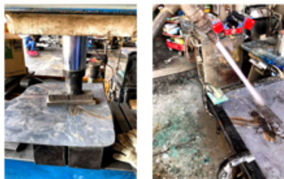
大まかにプレスで修正後、細かな亀裂及び歪みを修正します。
