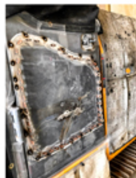
スパックシートで養生し、修正したパネルを溶接します。
