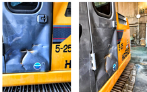
キャブが大きく破損しています。
