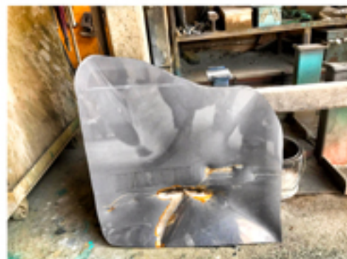
破損が激しいため、修正部のパネルを切り取ります。
