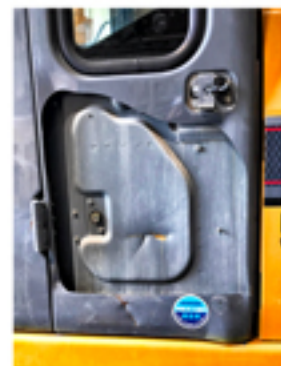
破損が激しいため、修正部のパネルを切り取ります。
