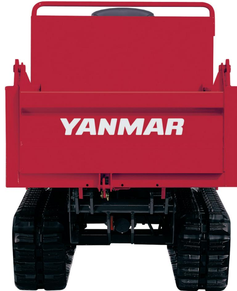
全幅 標準仕様 **950mm** / 三方ダンプ仕様 **960mm**
