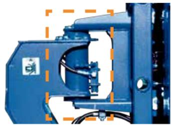
首振制御を油圧で行うロータリーアクチュエーターを採用。旋回動作で障害物に衝突するなど、バスケットに大きな荷重がかかった際に、首振機構が作動して荷重を逃がすことで破損リスクを低減します。
