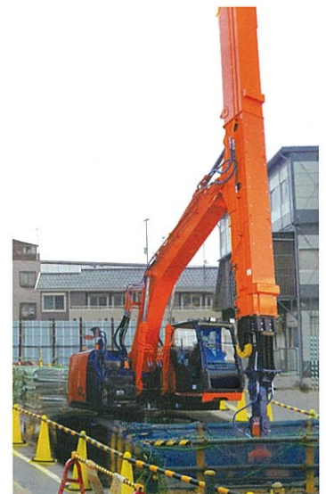
写真はZX225USRLC-5Bテレスコブーム仕様機です。
