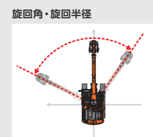
旋回角・旋回半径を設定し、掘削・ダンプ積込位置の目安に。
