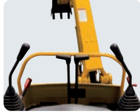
TOPS: 土工機横転時保護構造 (JIS・ISO) ヘッドガード: 落下物保護構造 (労働安全衛生法)
