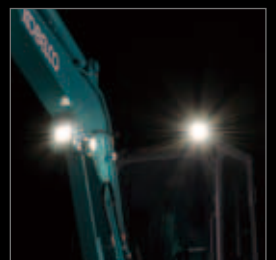
LED前方作業灯 画像はキャブ仕様。キャノピ ライトはオプションです。
