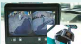
増設右カメラ+モニター 機械右サイドの状況を、別置きモニター上で確認可能。 オプション
