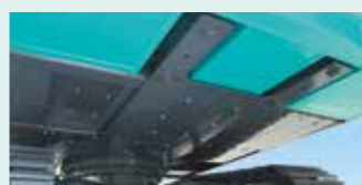
強化型上部本体アングカパー アッパ底面に厚さ6mmの強化型カバーを装備し、内部機器を保護。
