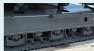
増設トラックガイド* 解体ガラの散乱する不整地走行時でもシューの脱輪を防止。 オプション
