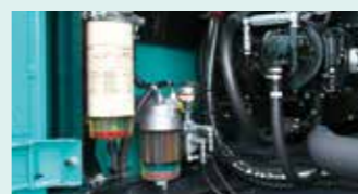
新型燃料フィルタ ウォーターセパレーター型体のプレフィルタを追加して過性能を向上。
