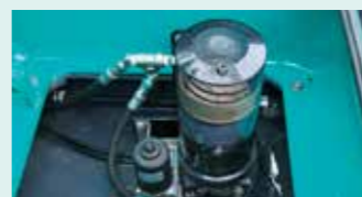
アタッチメント自動給脂装置* 決められた時間ごとに自動的に給脂。始業時給脂の煩わしさをカット。
