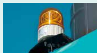
黄色回転警告灯 周辺作業者に稼働中であることを知らせ注意を喚起。 オプション
