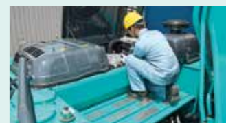
メンテナンススペース 燃料給油やボンネット内の点検などが楽な姿勢で行える本体上部空間。
