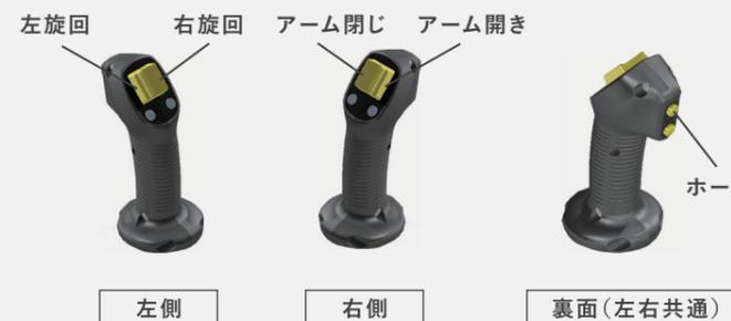
油圧ペダルを踏みながら、左右のグリップスイッチでアタッチメントを操作。直感的で、操作性に優れた形状です。操作速度はペダルの踏み量で調節します。
