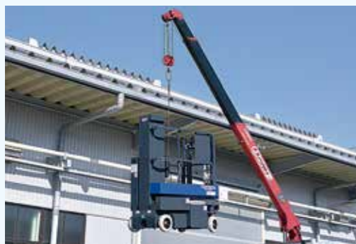
積み下ろし作業(センター吊り) ※屋外保管も可能です。
