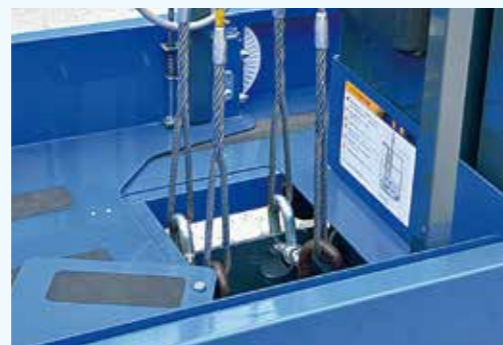
吊り具の取付箇所を集中して配置。 スムーズな積み下ろし作業に貢献します。
