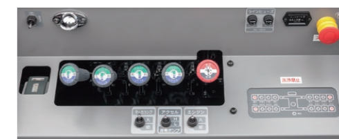
車両後端操作部
